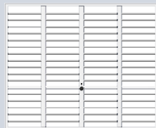
Wzór 904 Okrągłe profile (Ø 12 mm, odstęp 100 mm)
